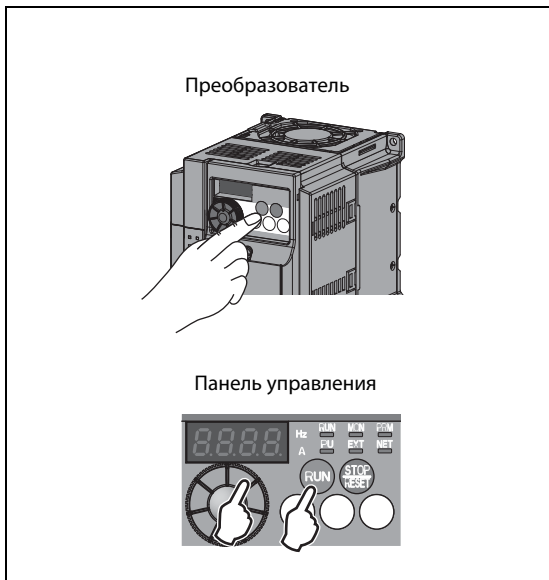
Рис. 6-93: Управление через пульт управления
